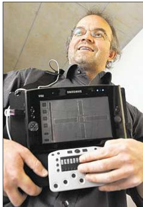
SCHRIFTLICHER HINWEIS: Andreas Hub führt den Prototyp seines Blinden-Navigations-systems vor. Der tragbare Rechner ist unter anderem mit einer Braille-Zelle ausgerüstet, an der Nutzer Informationen ablesen können. Foto: Murat
